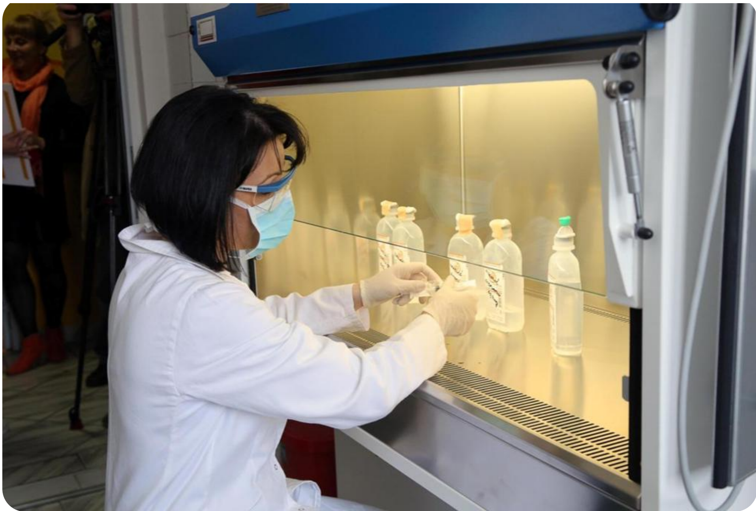
Laminarna komora za rastvaranje citostatika, Institut za zdravstvenu zaštitu dece i omladine Vojvodine
